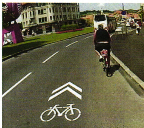
Slika 7-9: Talna označba »Kolesarji na vozišču« in prikaz označitve iz realnega okolja.
